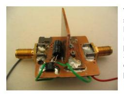
Vue sur le bout de cuivre soudé directement sous le CI et servant de radiateur et de support pour fixer le transistor. Serrer dans l'étau car ça chauffe quand même un peu.
